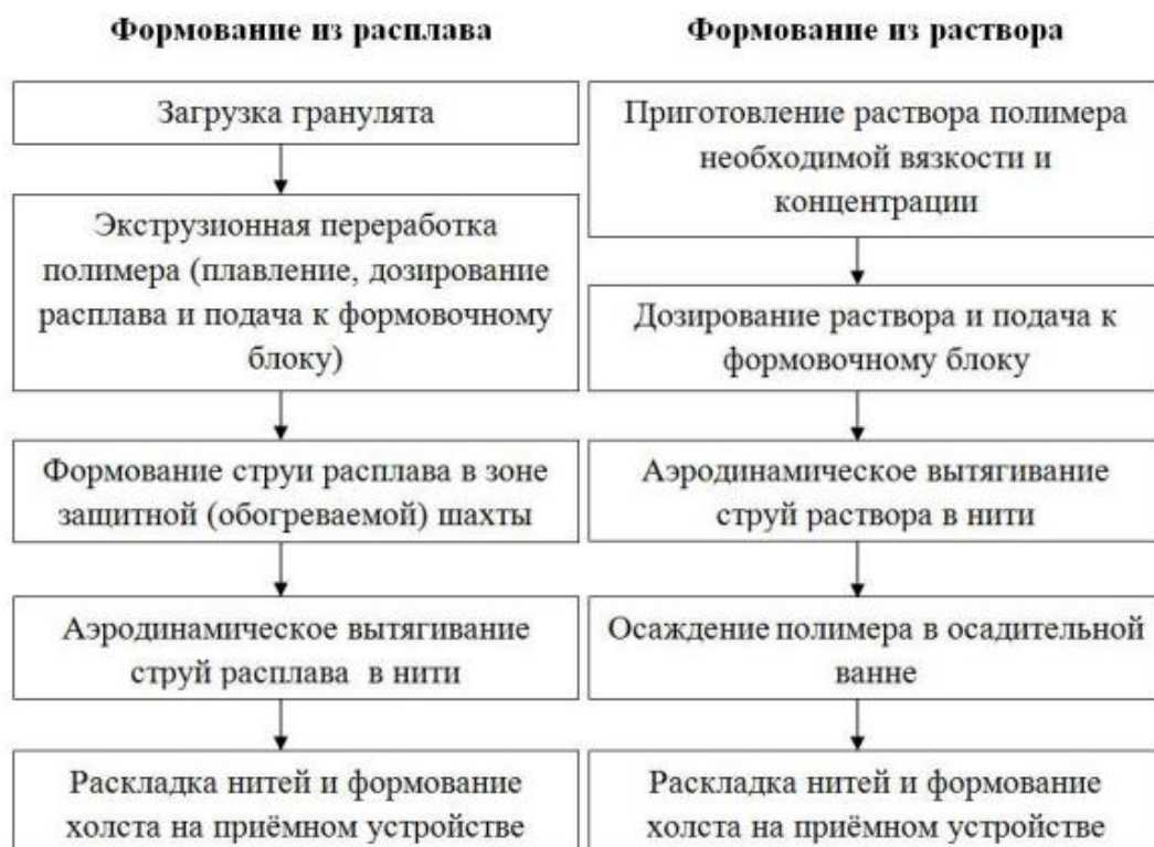
Рис. 1. Принципиальная схема способа аэродинамического формирования из полимерных расплавов и растворов
