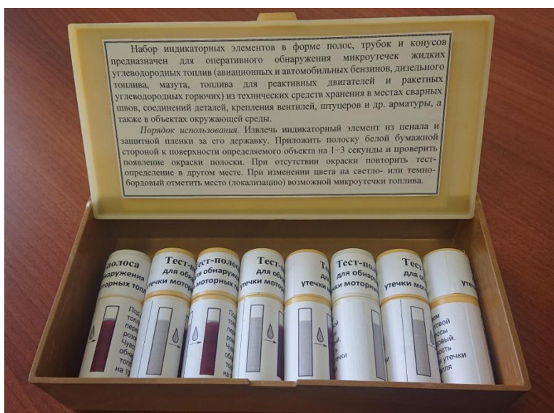
Рис. 2. Комплект полос ИНТ для определения утечки жидких ГСМ
